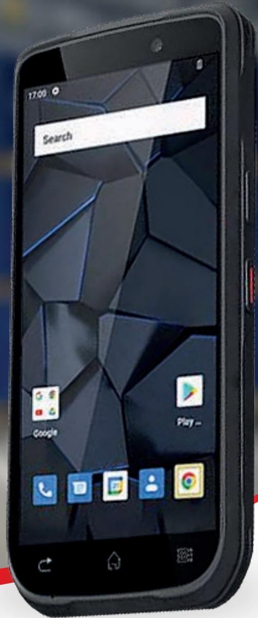
La TLM X160 es una PDA industrial versátil y resistente, diseñada para satisfacer las necesidades de entornos de trabajo exigentes. Con un sistema operativo Android 12.0, esta PDA ofrece una experiencia de usuario fluida y moderna.
