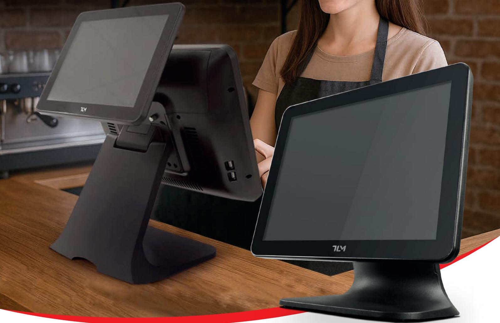
Der TLM 500 Point-of-Sale-Terminal zeichnet sich durch seine hohe Stabilität und Eleganz aus, mit einem kapazitiven 15-Zoll-Touchscreen. Er verfügt über ein Design mit klaren Linien und hochwertigen Materialien. Hergestellt aus leichtem ABS-Material und einem Metallfuß für einen bequemen, komfortablen und stabilen Einsatz.
