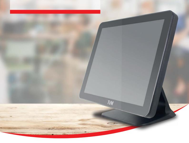
El tpv **TLM 700** sorprende por su gran pantalla capacitiva de 17 pulgadas, para parada para trabajos que necesiten mucho espacio o software que necesite orgranizar la pantalla con varias ventanas al mismo tiempo. Fabricado con un ligero **material ABS y pie metálico** para hacer un equipo cómodo, confortable y estable.
